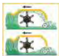
Funcionamiento bidireccional del cabezal triturador.
