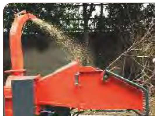
Rodillo más cuchilla fija ALTURA DE DESCARGA 2000 mm
